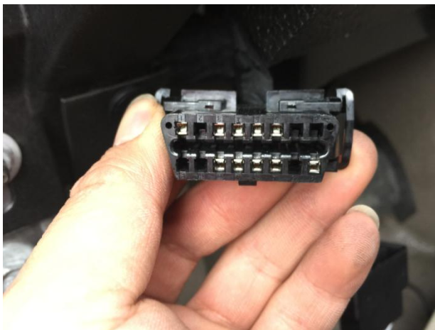
接原车 OBD 接头 拆卸的原车 OBD 与我司配的 OBD 对接，
