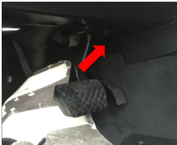
右踏板电机布线：把电机线通过脚下海绵，穿过副驾驶位。（右边电机线较长）
