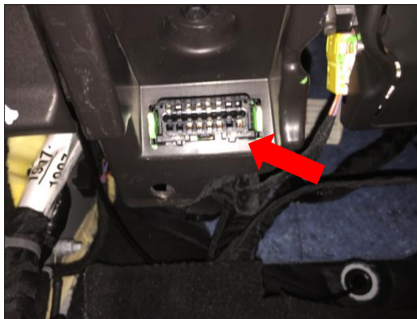
接原车 OBD 接头 在中控台位置拆卸此处原车 OBD ；
