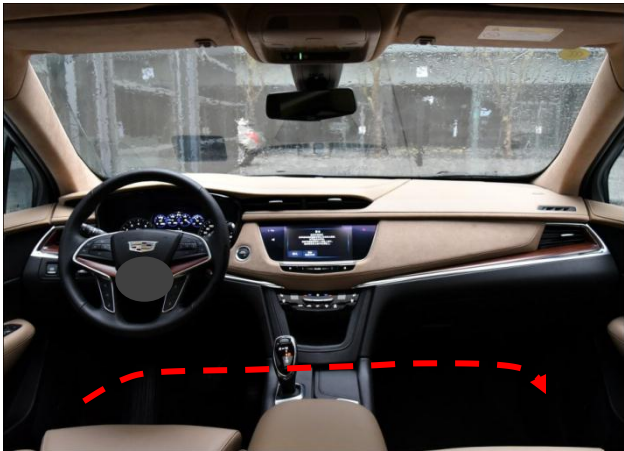
右踏板电机布线：把电机线通过脚下海绵，穿过副驾驶位。（虚线） 提示：右边踏板电机线较长
