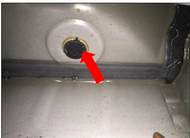
踏板电机穿线孔：将右电机线由此孔穿进车内（箭头），然后把胶塞穿进线内，待线穿好后车底对应孔周边打防水胶，把孔封好防止进水。左右两边踏板电机穿线孔方法一致；
